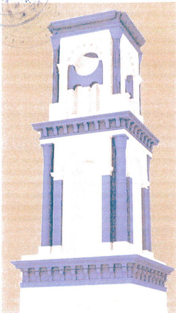
εικ. 7-2 : Τμήματα Κωδωνοστασίων που προτείνεται να καθαιρεθούν και να ανακατασκευαστούν επαναχρησιμοποιώντας τους λίθους και τα λαξευτά μέλη που κρίνονται υγιή.
